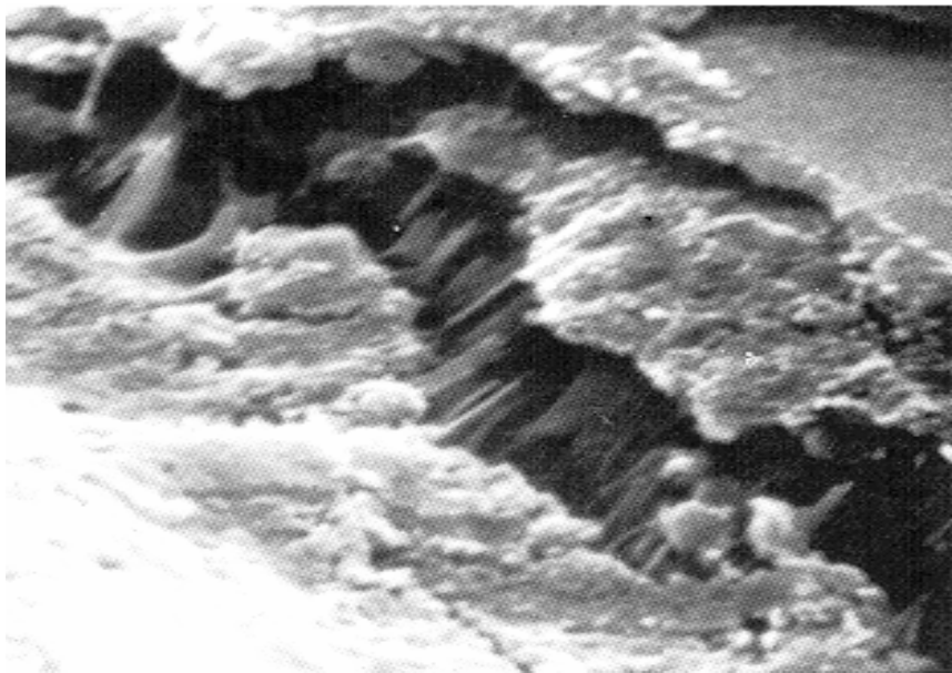
Figura 1. Fissura em concreto modificado com polímero. FONTE: TEZUKA (1988) [1] .
