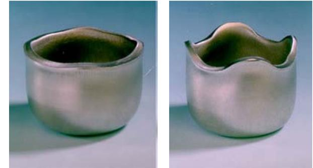
La anisotropía puede provocar flujos de material diferentes en las diferentes direcciones durante el conformado. En el ejemplo, una copa correctamente embutida (izquierda) y defectuosa (derecha) como consecuencia de la anisotropía
