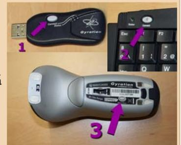
Accionar el botón de conexión del teclado (2) y el botón de conexión del ratón (3). La luz del receptor dejará de ser intermitente. Ya están sincronizados.
