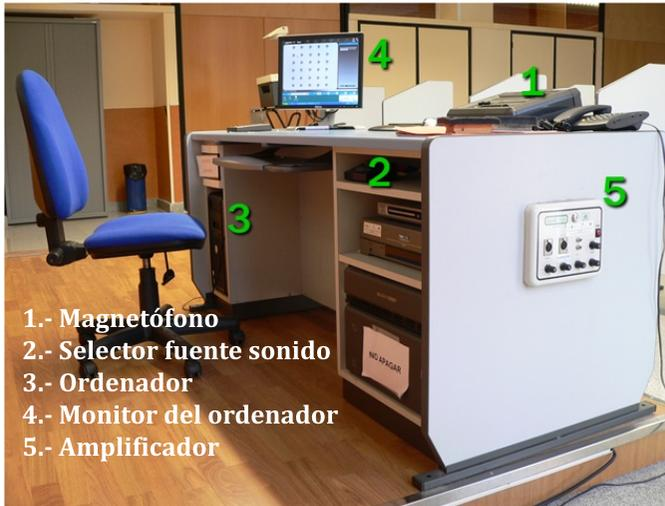
PASO 1: Encender el magnetófono (nº1) e insertar la cinta que queremos digitalizar. El botón de encendido está en la parte trasera del magnetófono. comprobar que se oye el sonido desde el propio magnetófono.
