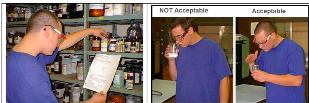
Siempre que uses sustancias volátiles utiliza una **vitrina extractora**. Si aun así se produjera una concentración excesiva de vapores en el laboratorio, abre inmediatamente las ventanas. **No inhales** los vapores de productos químicos Si en alguna ocasión tienes que oler una sustancia, la forma apropiada de hacerlo es dirigir un poco del vapor hacia
